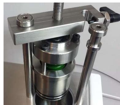
Il pistone in acciaio è fissato alla molla (parzialmente pre-caricata) e al contro pistone tramite 3 viti a colletto che consentono la compressione e decompressione della molla in pochi giri di vite e in piena sicurezza.
