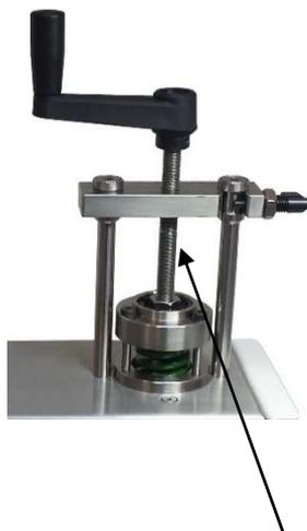
L'insieme "pistone – molla – contro pistone" è a sua volta fissato alla vite ma può ruotare liberamente; questo fa sì che per eseguire l'intero ciclo di lavorazione, non si deve smontare o montare alcun componente, soprattutto non è necessario toccare il pistone o la molla evitando rischi di ustioni, e si possono eseguire più cicli di lavorazioni consecutivi senza dover attendere il raffreddamento dei componenti per estrarre le pietre.
